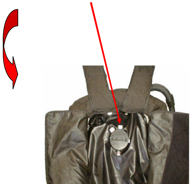
Boîtier porte injecteurs Dräger montés sur le sac inspiratoire
