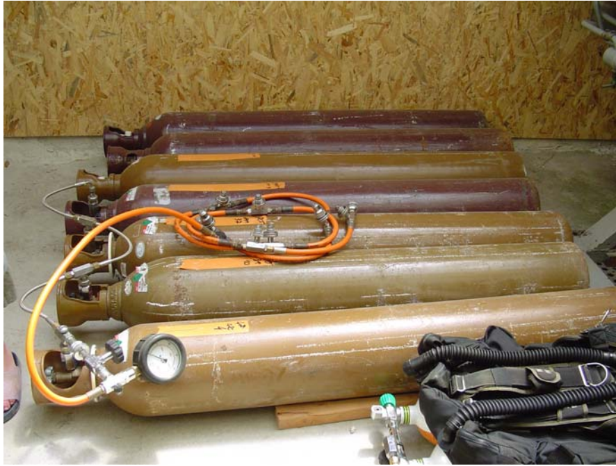
Bouteilles d'hélium d'une capacité de 50 litres à 200 bars fournies par les producteurs
